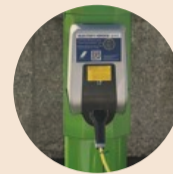
Electrify Verona. Un particolare dei pali della luce "smart", già operativi a Verona, prima città in Europa a sperimentarli. Sono dotati tra l'altro di una presa di ricarica veloce a 22 kW per vetture elettriche
